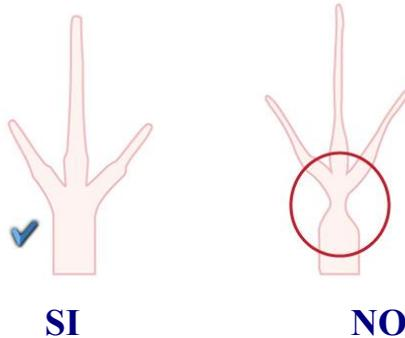
**Transición progresiva entre el conducto de entrada y los tres principales.**
