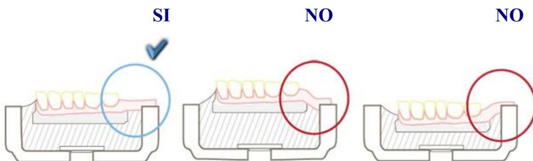
**Realizar conductos en cera. Los conductos deben seguir una trayectoria recta respecto del plano de ingreso del material en la inyección. Para ello, el modelo debe ubicarse en ese mismo plano, evitando desniveles. No debe estar enterrado ni muy elevado.**
